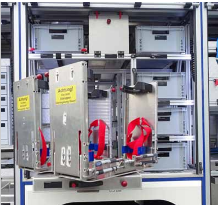
Geratefach 4: Halterungen fur Atemschutzgerate sind Zukauffteile und werden bei Freytag lediglich montiert.
