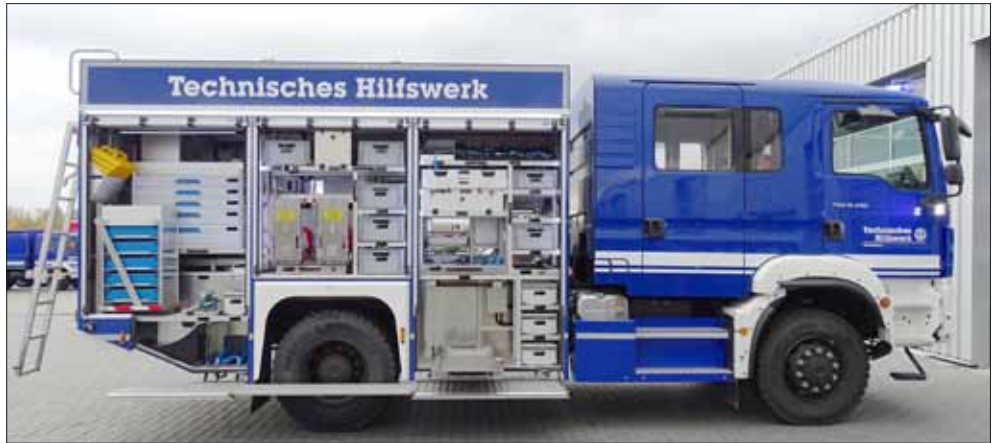
Auf den ersten Blick sieht man kaum Unterschiede zu vergangenen GWK-Serien, neu sind die Griffstangen an den Rollladen und die LED-Leisten als Umfeldbeleuchtung.
