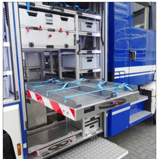
Geratefach 2: fur Leitungsrollen hat man auf moglichst viele Bau-typen anpassbare Halterungen verwendet.
