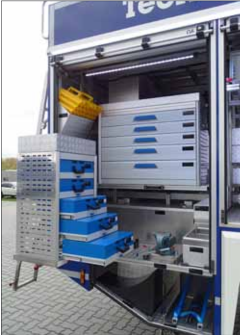
Geratefach 6: ausklappbarer Werkzeugtresor mit weniger Schubladen als bisher.
