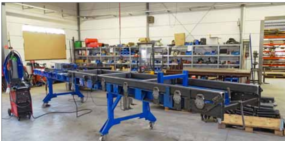
Die Hilfsrahmen werden von Freytag selbst als Schweißkonstruktion gefertigt.
