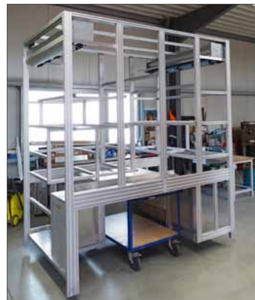
Die Aufbauten entstehen aus Standard-Aluminiumprofilen mit speziellen Verbindungselementen nach Freytag-Vorgaben.
