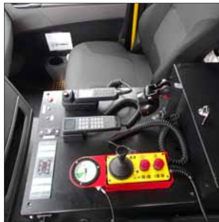
In Cockpitmitte Bedienelement, Seilwindenschaltung, Funk und Leuchtenausstattung.
