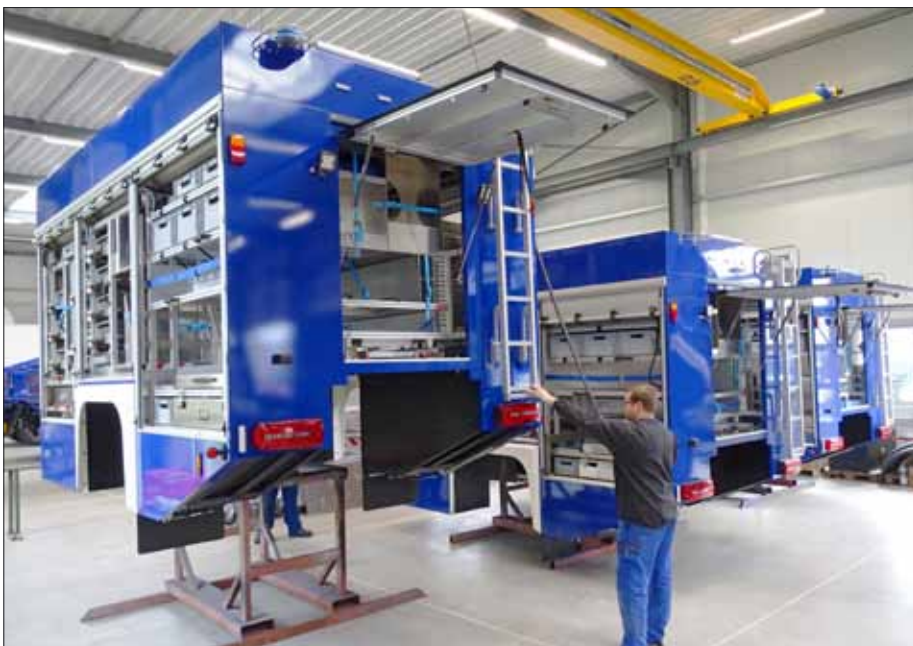
Alle GKW-Koffer werden vorausgerüstet mit der Elektrik, den Fächern und den Anbauten.
