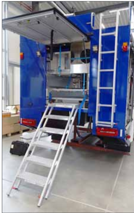
Das Heck ist für einen GWK deutlich verändert: die Treppe ist im Koffer gelagert, dafür sind die Baustützen auf dem Dach und die Leiter hat einen ausziehbaren unteren Aufstiegsteil.
