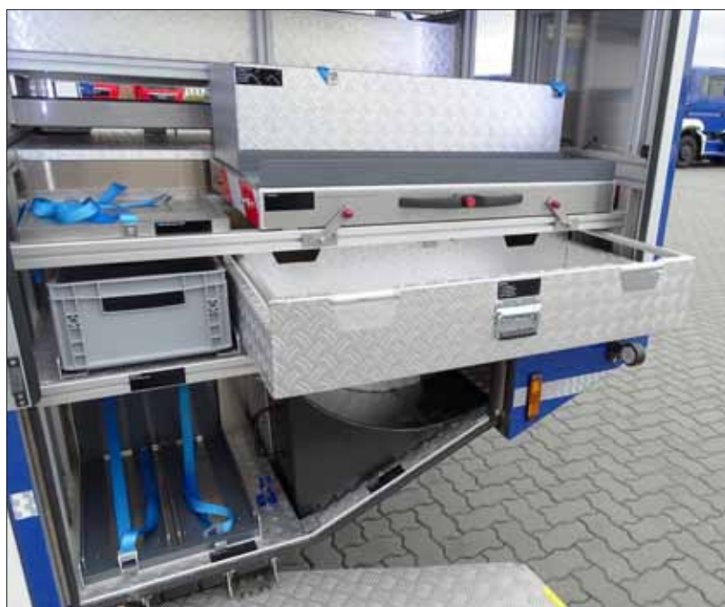
Gerätefach 5: Fach für die schweren Anschlagmittel mit umfangreichen Griffmöglichkeiten deutlich verbessert.
