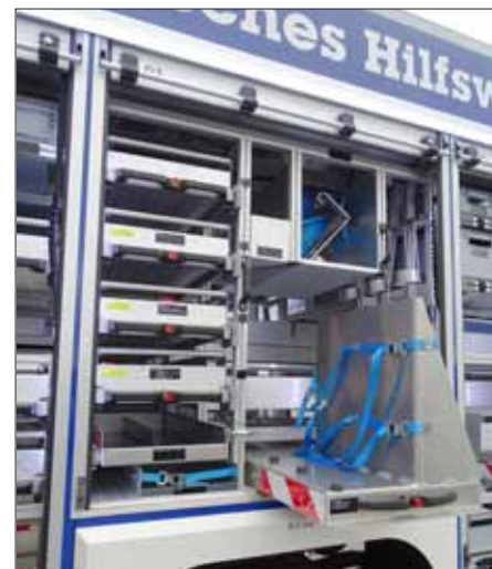
Gerätefach 3: Halterung für Tauchpumpen mit flexiblen Zurrgurten für den im THW vorhandenen Gerätemix.
