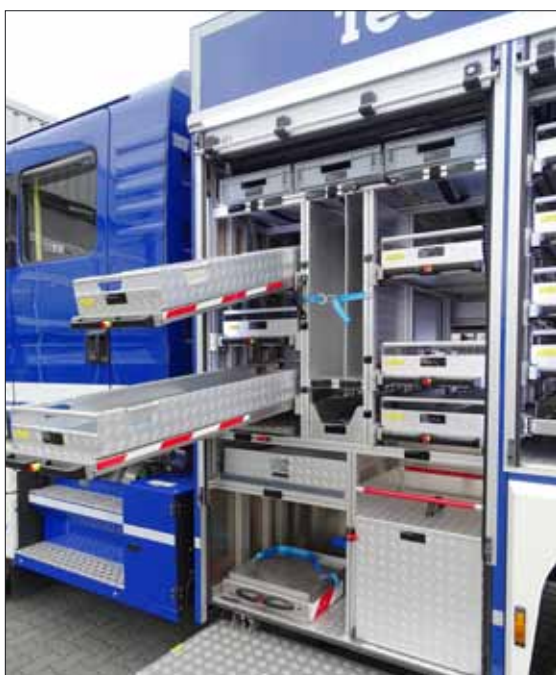
Gerätefach 1: Langfächer Motorsäge, Schere & Spreizer für bessere Entnahme modifiziert.
